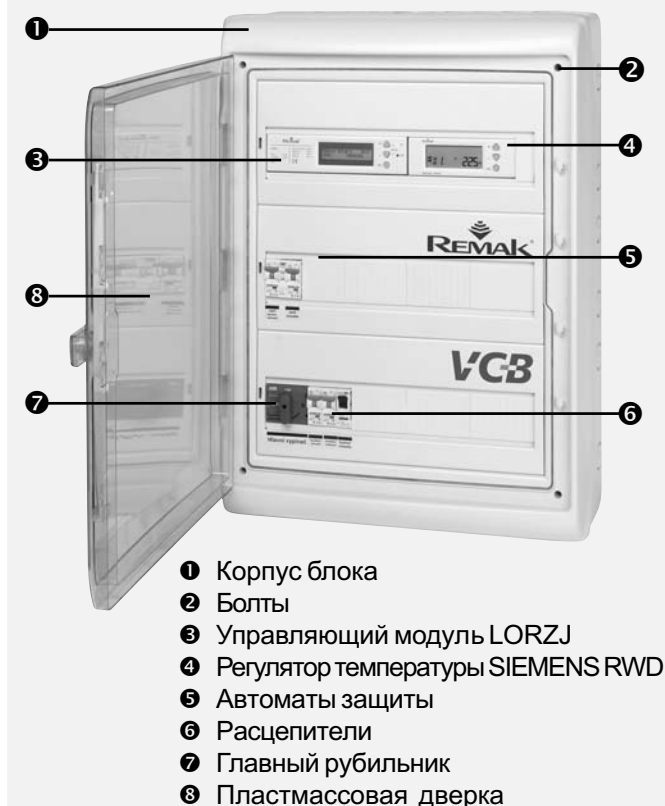
Рис. 4 – конструкция блока VCB
