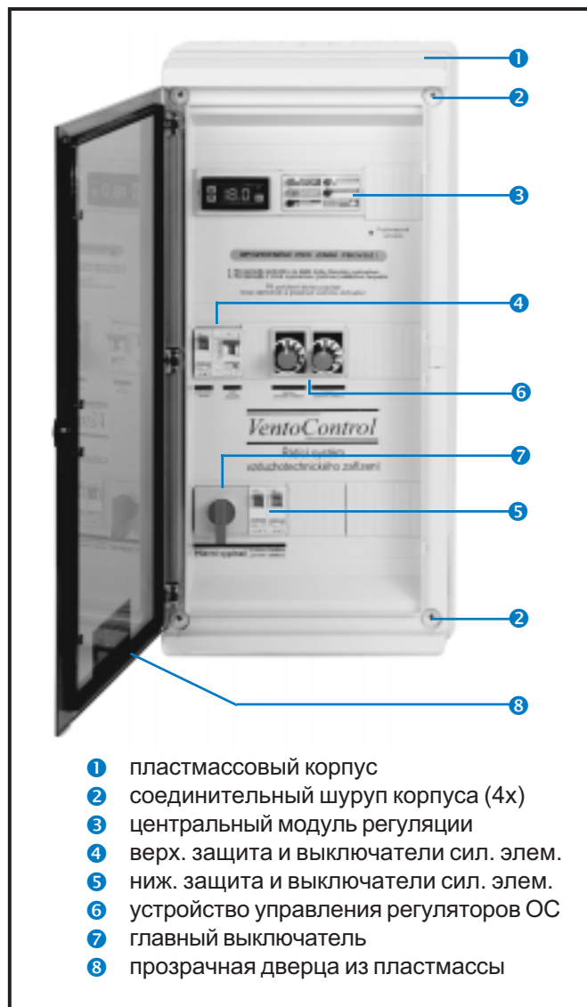
Рис. 2 – Фронтальная панель VentoControl VCA
